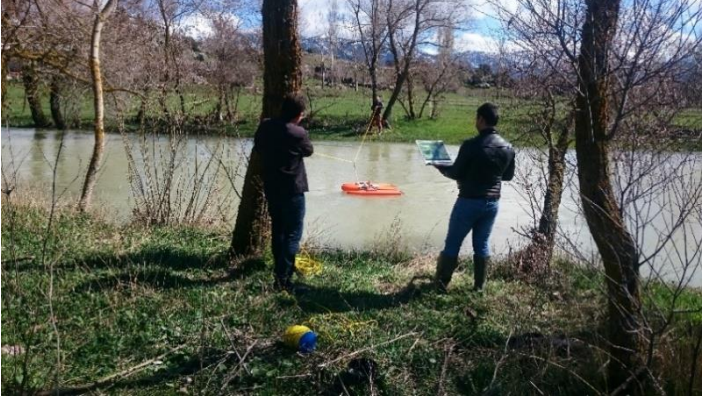
Şekil 14 ADCP Cihazı ile Yapılan Debi Ölçümü (DSİ K. Maraş Bölgesi, 2019)
