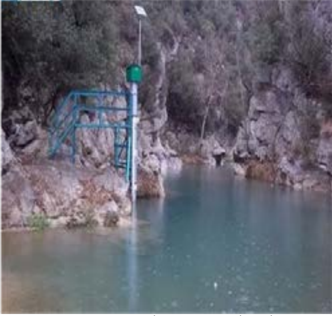
Resim:1 Akım Gözlem İstasyonu (AGİ)(DSİ Arşivi)
