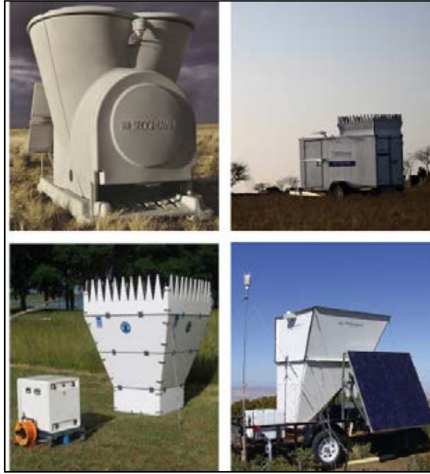
Şekil 3. En yaygın kullanılan SODAR cihazları (saat yönünde: Second Wind Triton; AQSystem AQ500; Metek PCS2000-24/LP; ASC 4000i).
