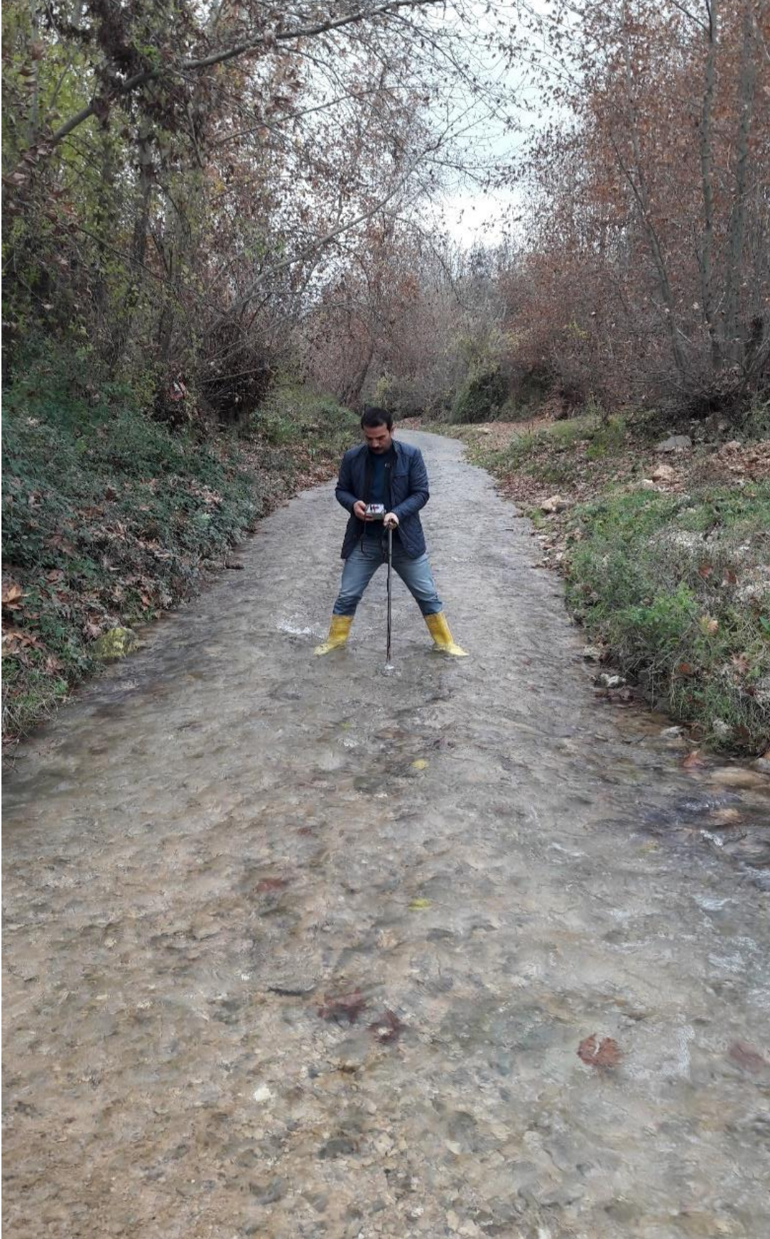
Resim 1 Debi Ölçümünde Kullanılan Muline Cihazı ile Suyu Girilerek debi ölçümü, (D21T004 Bulaklı İstasyonu Şanlıurfa DSİ, 11.12.2019 - 12.28)
