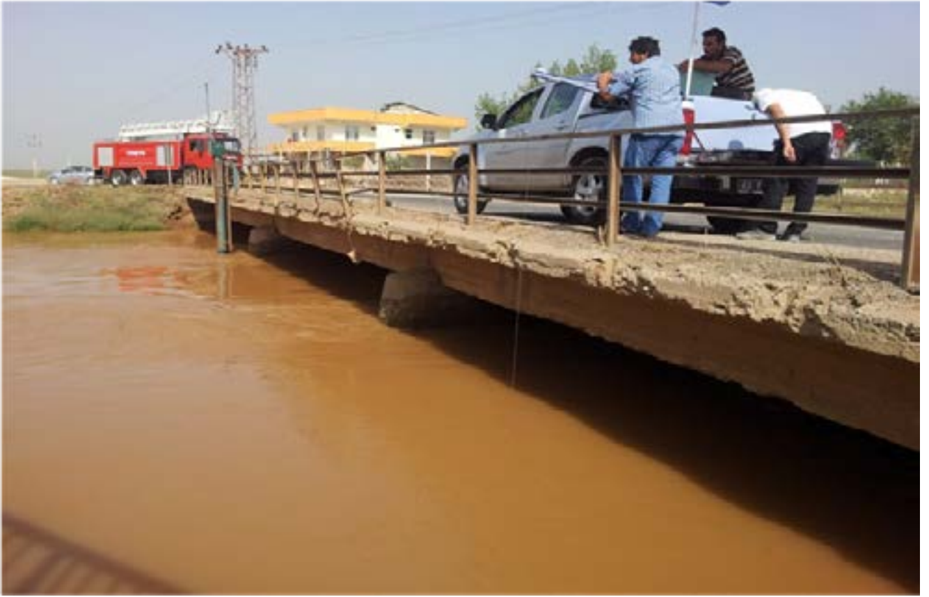
Resim 2: Muline Cihazı ile Araç kreni ile askıda debi ölçümü (D21A146 Arıcan Şanlıurfa İstasyonu, DSİ 12 09 2015 - 10.12)
