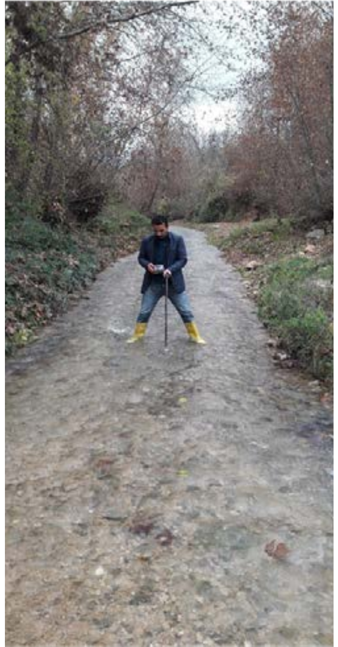
Resim 1: Debi Ölçümünde Kullanılan Muline Cihazı ile Suya Girilerek debi ölçümü (D21T004 Bulaklı İstasyonu Şanlıurfa DSİ, 11.12.2019 - 12.28)
