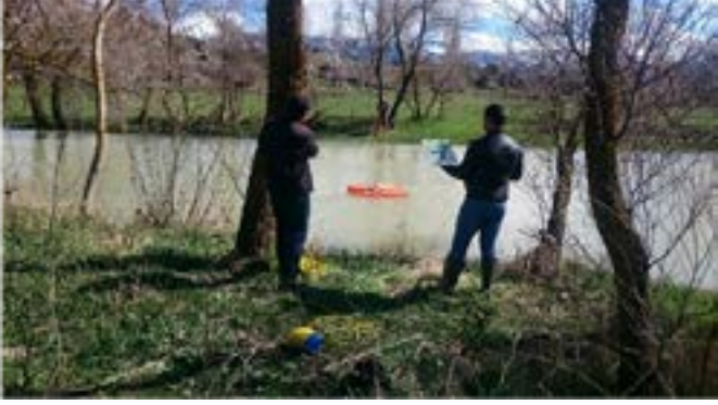
Şekil: 15 ADCP Cihazı ile Yapılan Debi Ölçümü (DSİ K. Maraş Bölgesi, 2019)
