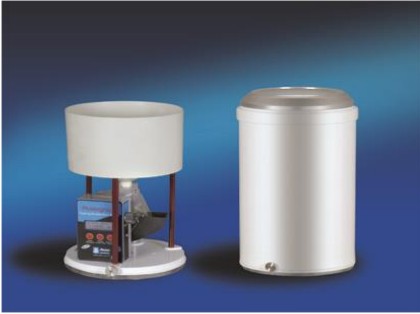
Şekil 1 Plüviyograf cihazının içi ve dışının görünümü
